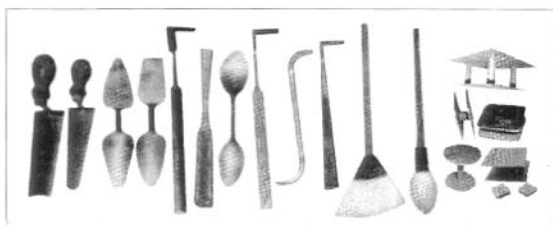
图中从左至右依次为: 1.刮刀 2.尖刮刀 3.压勾 4.单齐压勾 5.提钩 6.单头钢批 7.秋叶 8.单开提钩 9.法兰钩
